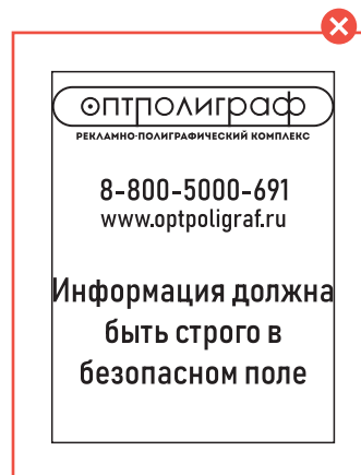
Неправильно подготовленный макет Информация расположена близко к краям макета. Часть текста не пропечатается. Черный текст 0.0.0.100
